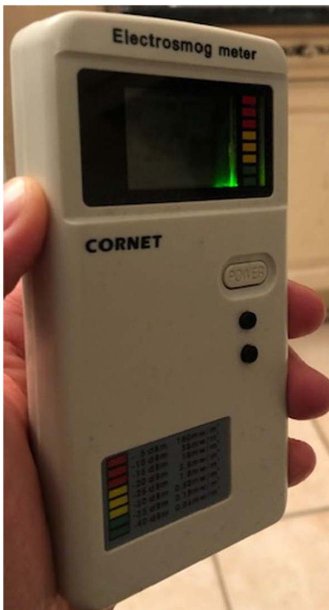
Cornet ED78S (mesure intensités champs électromagnétiques de hautes fréquences de 100 MHz à 8 Ghz) : <https://tinyurl.com/mr36ezvh>
