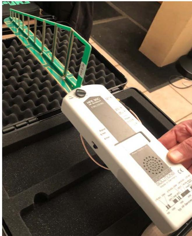
Gigahertz Solutions HFW35C (mesure intensités et directions des champs électromagnétiques de hautes fréquences de 2,4 GHz à 6 GHz) : <https://tinyurl.com/2p8dbre3>
