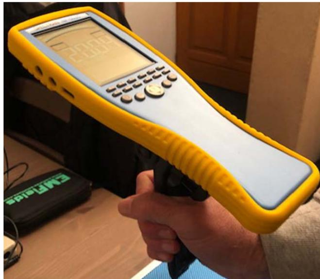
Aaronia Spectran NF-5030 (mesure des fréquences basses de 1 Hz à 30 MHz) :
