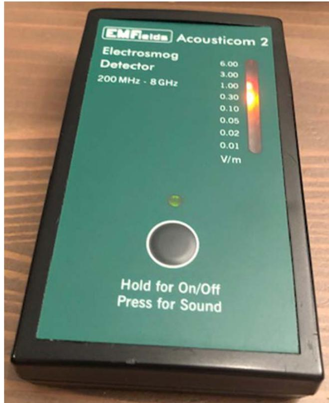
EM Fields Acousticom 2 EMF detector (mesure intensités des champs électromagnétiques de hautes fréquences de 200 MHz à 8 GHz) : <https://tinyurl.com/5n7ptvbw>
