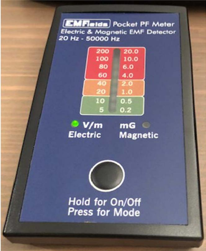
EM Fields Pocket PF Meter Electric & Magnetic EMF detector (mesure intensités des champs électriques et magnétiques de basses fréquences de 20 Hz à 50 KHz).
